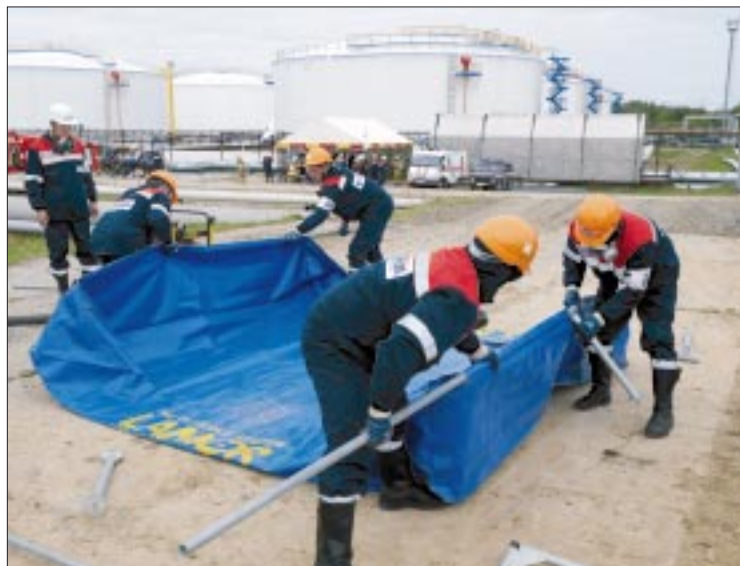
На вооружении спасателей-экологов самое современное оборудование, например, скиммеры (нефесборщики) и резервуары из маслостойких материалов для сбора нефтяных отходов
