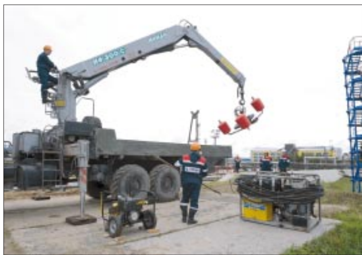
Монтаж оборудования для сбора и утилизации нефтезагрязнений даже в самых труднодоступных районах занимает несколько минут
